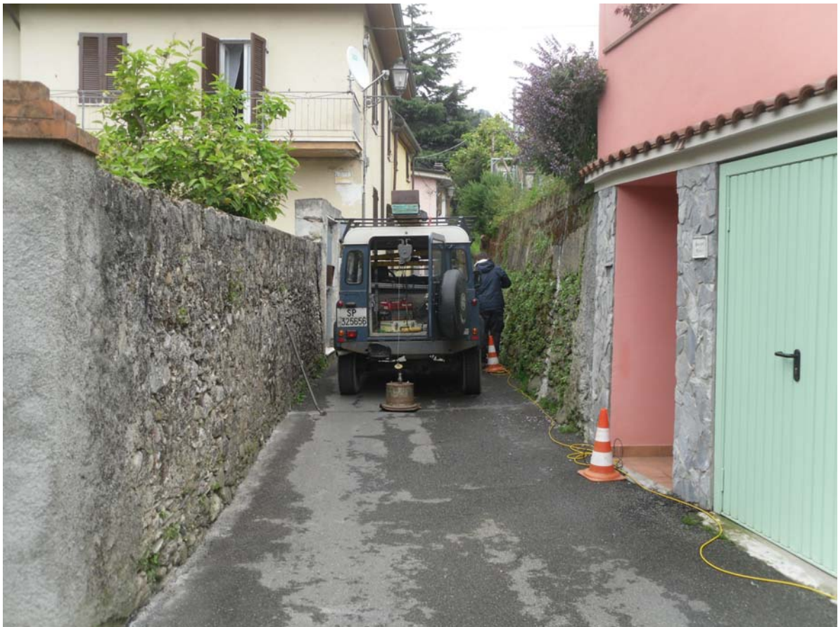
Foto n.1 Energizzazione con il grave in caduta libera per la produzione di onde P (colpo intermedio sinistro D1 ).
